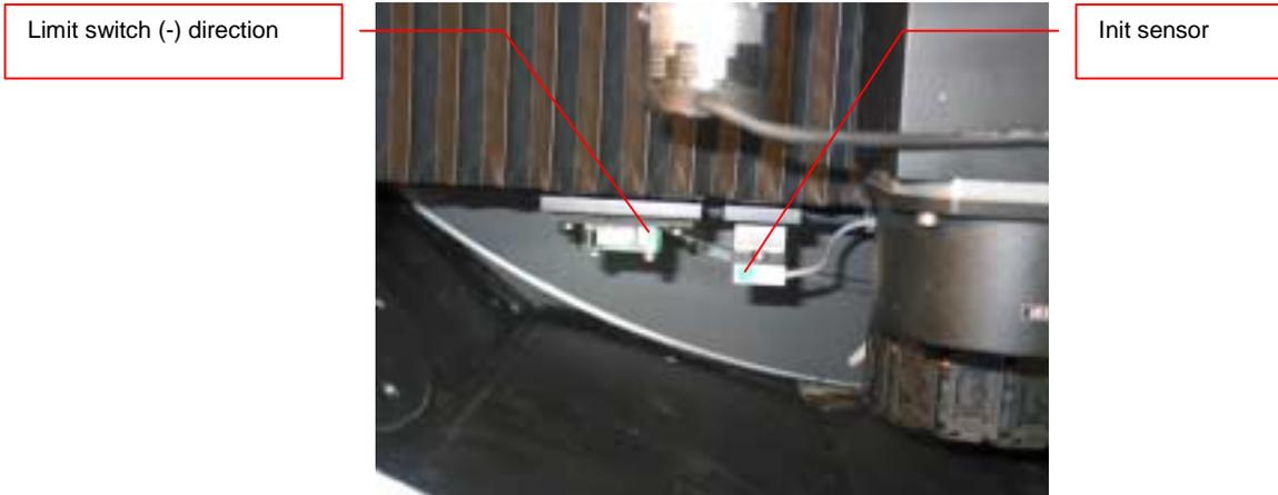
Fig. 5.4\_43. Limit switches
